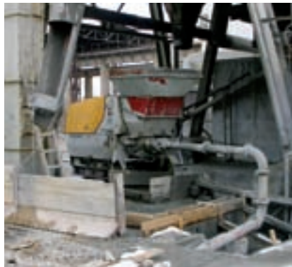
Die für kleine Fördermengen entwickelte Betonpumpe P 715 befindet sich unter der Mischanlage (Abb: Betonika plus)
